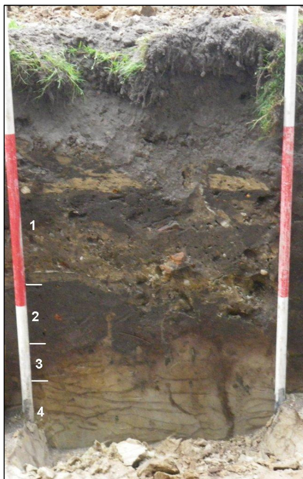
Afbeelding 3.2: profielkolom 2.1 met van boven naar beneden, 1) recent opgebrachte/verstoorde lagen, 2) ouder plaggendek, Aa-horizont, 3) restant B-/BC-horizont met humusbandjes, 4) C-horizont, dekzand
